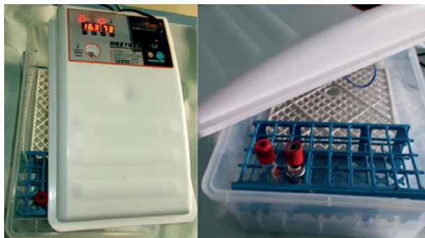
Figura 1. Incubatore utilizzato per mantenere le provette ad una temperatura costante di 37°C.
